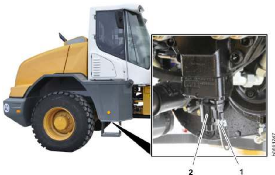
Fig. 264: Distacco del magnete proporzionale sul motore di trazione
