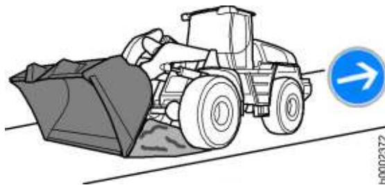
Fig. 233: Livellamento in direzione di retromarcia
