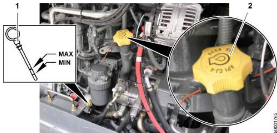
Fig. 299: Controllo del livello dell'olio per il motore Diesel
