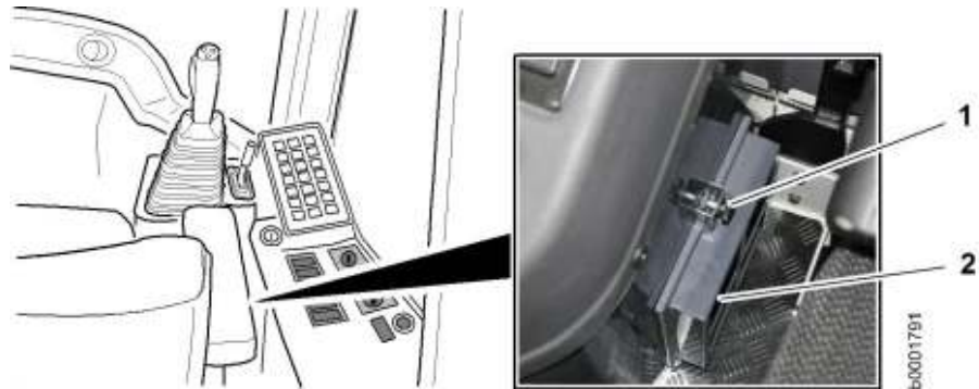
Fig. 336: Pulizia del filtro dell'aria di ricircolo
