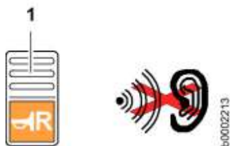
Fig. 174: Disinserimento del dispositivo di segnalazione acustica di retromarcia
