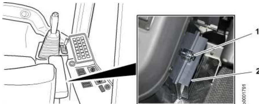
Fig. 338: Sostituzione del filtro dell'aria di ricircolo
