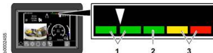
Fig. 218: Stato di caricamento del filtro antiparticolato per motori Diesel
