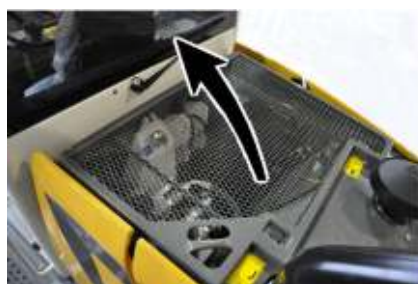
Fig. 313: Controllare la concentrazione dell'additivo antigelo
