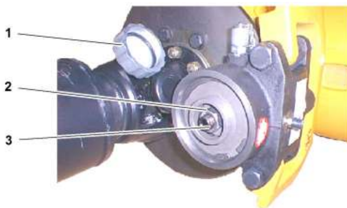
Fig. 265: Disinnesto meccanico del freno di stazionamento
