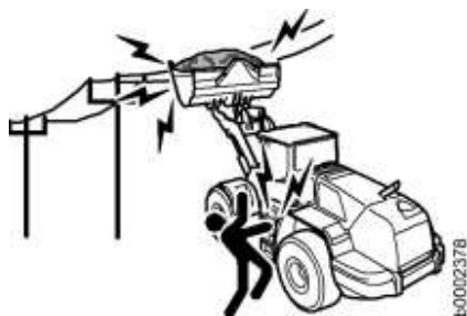
Fig. 238: Lavori in prossimità di linee elettriche aeree
