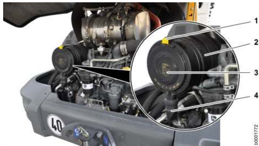
Fig. 305: Pulizia del coperchio del filtro dell'aria
