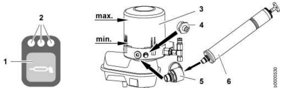
Fig. 342: Controllo del livello del serbatoio del grasso
