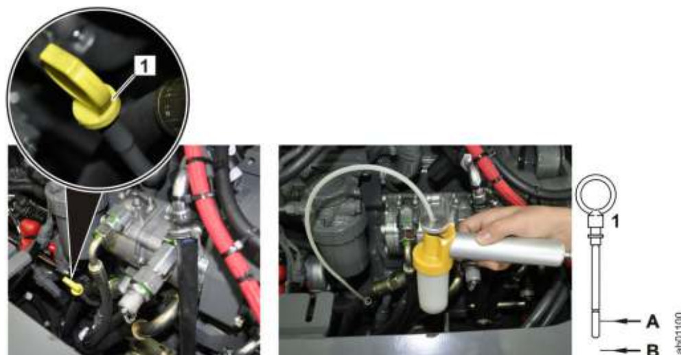
Fig. 295: Punto di prelievo nel motore Diesel
