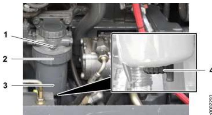
Fig. 303: Cambio del filtro fine del carburante
