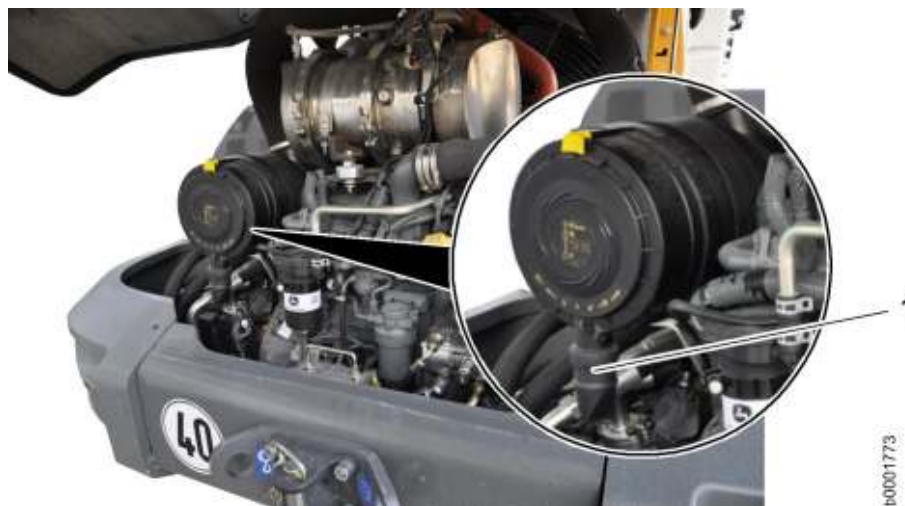
Fig. 306: Pulizia della valvola di espulsione della polvere
