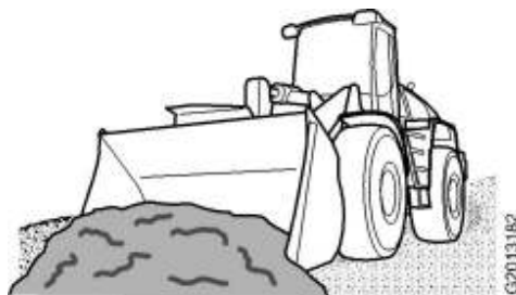
Fig. 232: Livellamento in direzione di marcia in avanti
