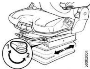
Fig. 83: Attivazione e disattivazione del molleggio orizzontale del sedile del conducente
