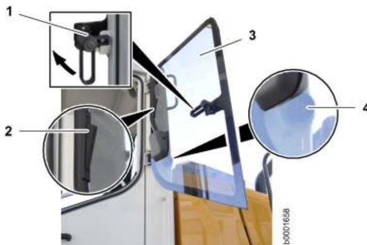
Fig. 66: Apertura del finestrino sinistro
