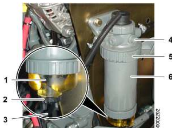
Fig. 302: Sostituzione del prefiltro del carburante
