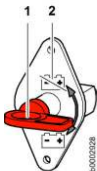
Fig. 200: Spegnimento dell'interruttore generale della batteria
