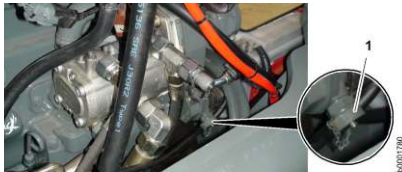
Fig. 314: Correzione della concentrazione di additivo antigelo
