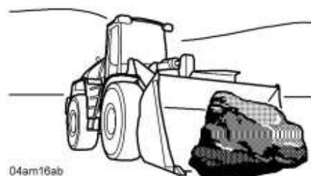
Fig. 239: Caricamento di rocce di grandi dimensioni
