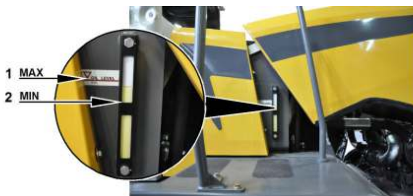
Fig. 320: Controllo del livello dell'olio idraulico
