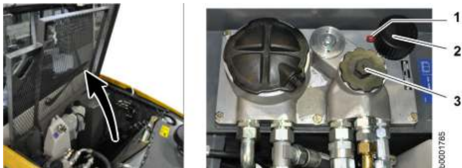
Fig. 321: Rabbocco con olio idraulico
