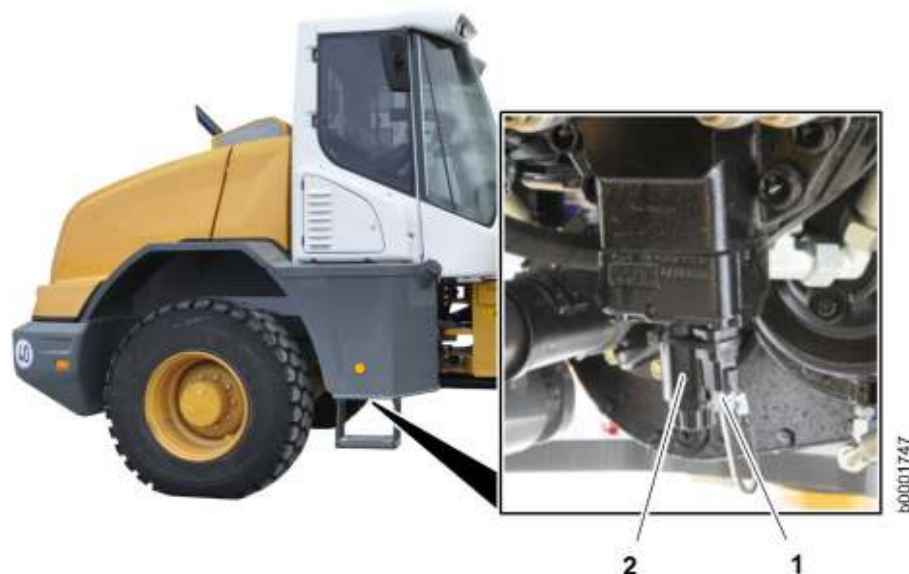
Fig. 261: Distacco del magnete proporzionale sul motore di trazione
