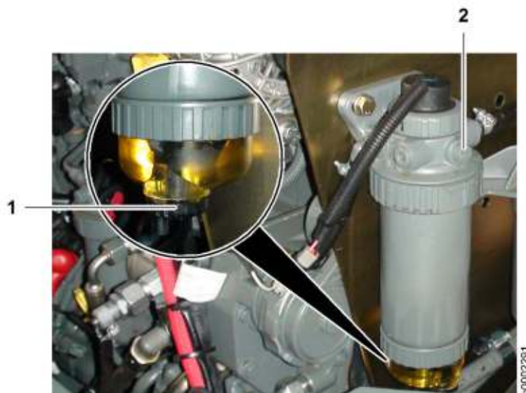
Fig. 301: Scarico della condensa dal prefilto del carburante
