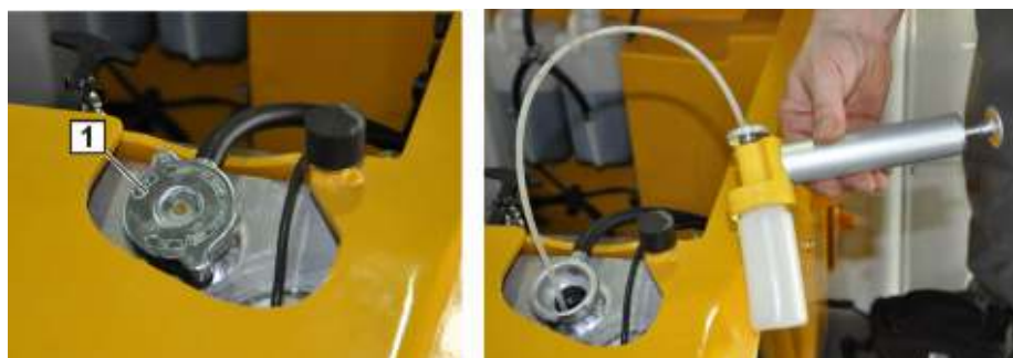
Fig. 296: Punto di prelievo del liquido refrigerante
