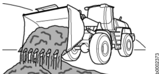
Fig. 231: Svuotamento dell'attrezzatura di lavoro
