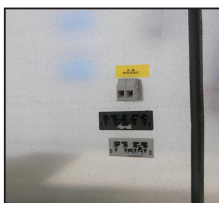
Gestione a morsettiera degli allarmi ON/OFF remoto (micro-interruttore apertura porta). Allarme sovratemperatura. RS485 collegamento seriale con controllo remoto fino a 32 unità (a richiesta).
