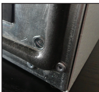
Guarnizione in poliuretano applicata in colata continua
