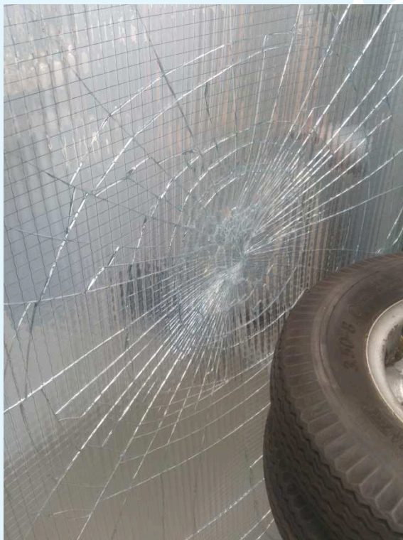
Esempio di rottura conforme a 450 mm.
