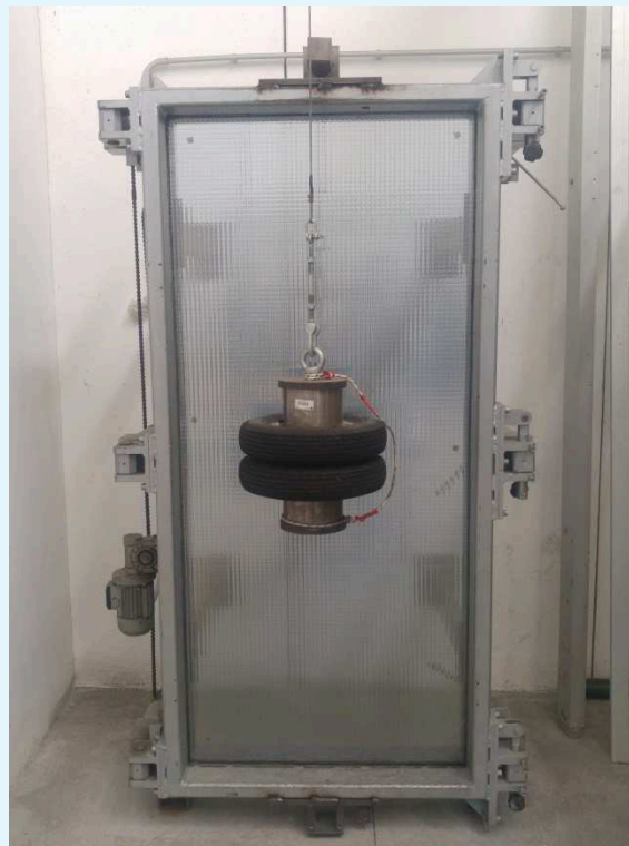
Fotografia di una lastra dopo impatto sul lato con pellicola.
