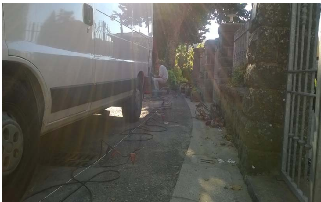
Profilo ST1 – Stralcio dello stendimento geofonico e sito indagato.
